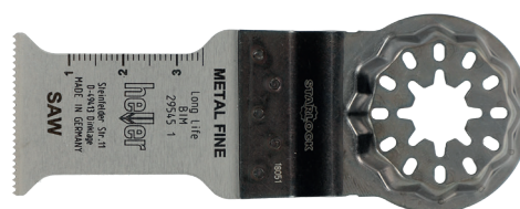
Sierra para metales finos BIM, 50 x 30 mm Dentado fino, chapa de acero, aluminio, cobre, plástico reforzado con fibras de vidrio. Especialmente precisa. n.º art.: 29545 1
