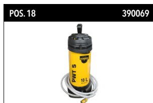
KBZ 700 PWT S Depósito agua a presión 10 l Diseño de gran calidad en acero con válvula de presión. Para realizar perforaciones en húmedo independientes de la red. Conexión de agua apta para todas las perforadoras de núcleo SAMEDIA y enganche rápido, conexión de manguera 1/2".
