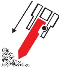
La posición correcta del trabajo debería ser vertical o en un ángulo de 90° hacia el nivel de trabajo. La herramienta, el martillo y la máquina portante deben formar una unidad.
