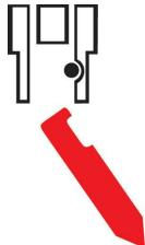
Aplique grasa de alta resistencia, especial para punteros, antes de montar la herramienta en el martillo.
