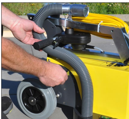
Fácil configuración de la máquina mediante mecanismo de inclinación + libélula.
